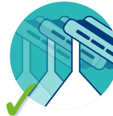
Verlagern Sie während des Befüllens der Schüttgutfächer regelmäßig den Abladepunkt, um Entmischung zu vermeiden.
