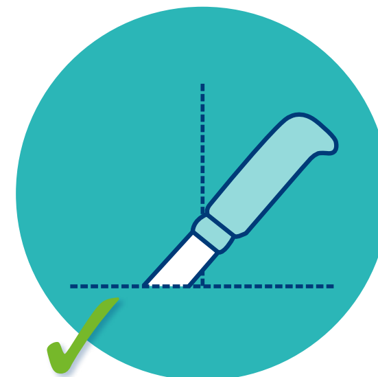
Maak een inkeping in de vorm van een omgekeerde T voor het opensnijden en legen van big bags
