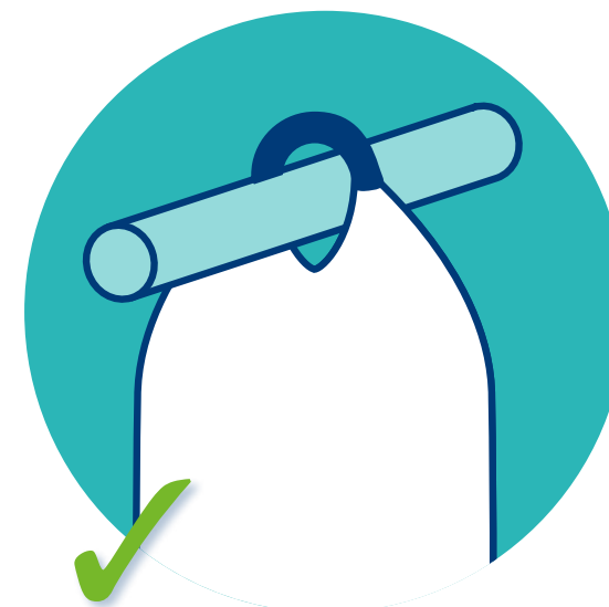
Big bags alleen optillen aan de speciaal uitgevoerde hijslus. Zorg daarbij dat de hijsinstallatie ronde hoeken heeft.
