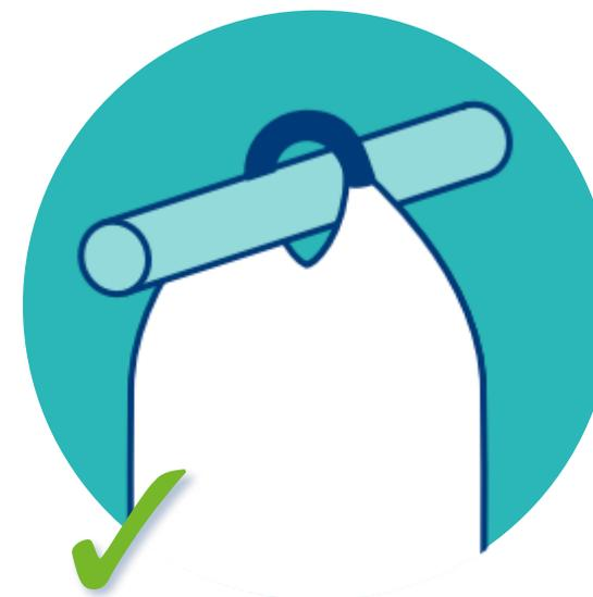
Heben Sie Bigbags ausschließlich mit der speziellen Hebeschleufe und der Hebeanlage mit abgerundeten Ecken an.
