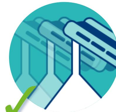
Verlagern Sie während des Befüllens der Schüttgutfächer regelmäßig den Abladepunkt, um Entmischung zu vermeiden.
