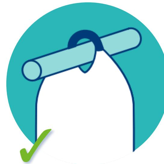
Ne soulevez les Big bags qu'à l'aide de la sangle de levage spécialement conçue et d'un équipement de levage aux coins arrondis.
